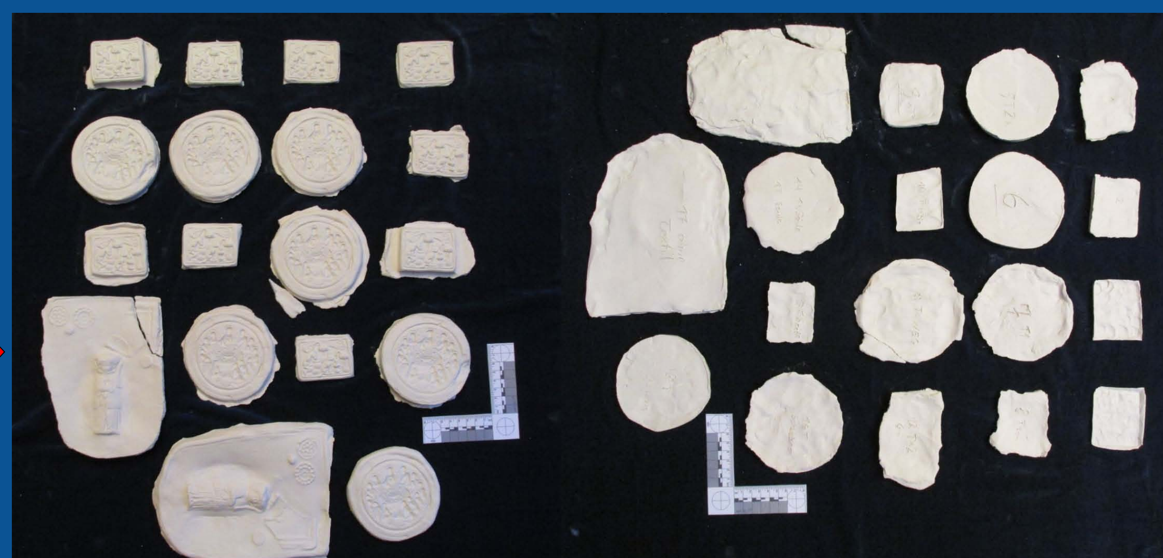
Schritt 5: Gesamtaufnahme (Vorder- und Rückseite) nach dem Brand. Brennatmosphäre leicht oxidierend, Brenntemperatur 950°C (freundliche Mitteilung Frau Remien, Fa. Knauber Bonn).
